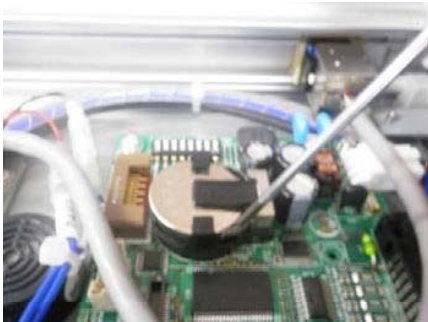
③ホルダー下部と電池の隙間にドライバーを入れる。
