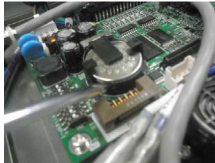
①ホルダーと電池の隙間にドライバーを入れる。
